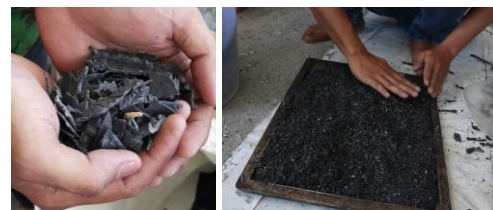
Gambar 18. Proses menata cacahan sampah plastik ke cetakan
