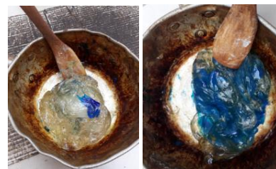
Gambar 9. Proses pengadukan plastik yang sudah dilelehkan
