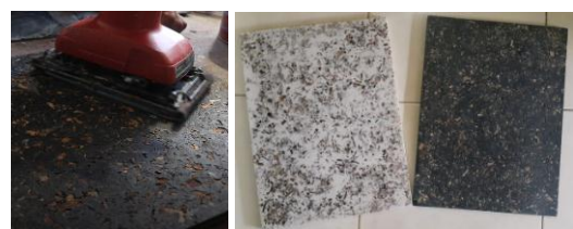
Gambar 20. Proses menghaluskan papan dan hasil jadi papan plastik yang dicampur serbuk kayu
