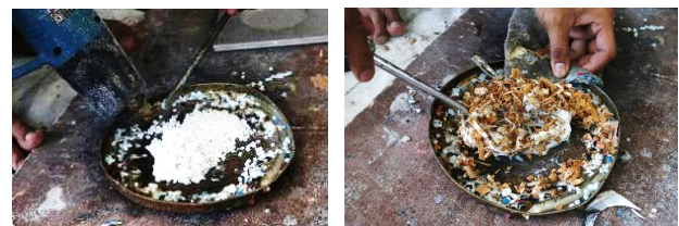
Gambar 4. Proses pelelehan plastik dan pencampuran dengan serbuk kayu kasar dengan menggunakan heatgun
