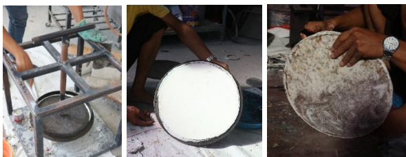
Gambar 7. Proses compressing dan hasil eksperimen kayu dan plastik untuk bidang yang berukuran besar
