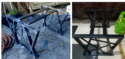
Gambar 31. Pembuatan dan hasil finishing kerangka kaki meja
