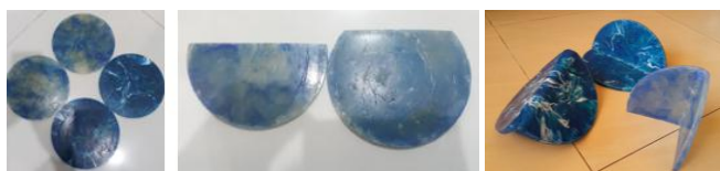
Gambar 29. Hasil jadi plastik lampu dan ketika di- bending
