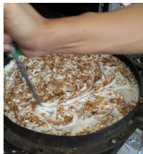
Gambar 6. Proses pencampuran kayu di cetakan berisi lelehan plastik dari oven di bidang berukuran besar
