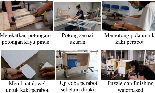
Gambar 25. Proses pembuatan produk Shape & Occupation
