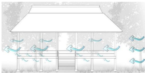
Gambar 5. Kemungkinan aliran Udara pada Bangunan Berpanggung
