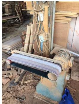
Gambar 6. Mesin amplas
