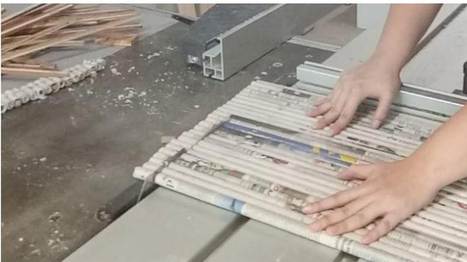
Gambar 7. Memotong menggunakan Table Saw
