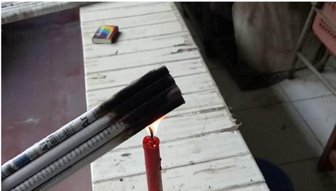
Gambar 6. Proses uji ketahanan api
