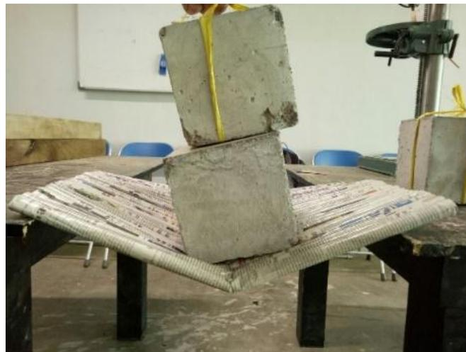
Gambar 5. Pengujian beban 20 kg
