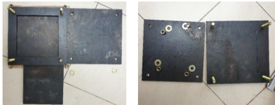
Gambar 2. Cetakan Besi Bentuk Persegi dan Segitiga Sama Sisi
