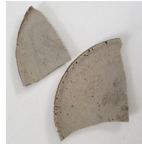
Gambar 1. Hasil Pemanasan PET Menggunakan Tungku
