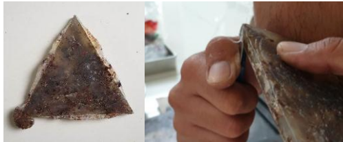
Gambar 3. Proses Perapian Sisa Plastik Pada Hasil Cetakan
