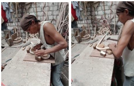
Gambar 34. Proses bending rotan (pembentukan) Foto : Preiscylia Jennifer, 2018
