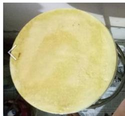
Gambar 2. Hasil cetakan bulat tutup cat dari *polyurethane foam*
