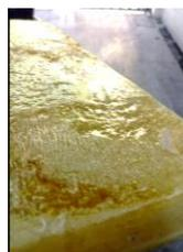
Gambar 4. *Polyurethane Foam* yang diberi resin
