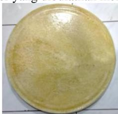
Gambar 3. Hasil cetakan bulat tutup drum dari *polyurethane foam*
