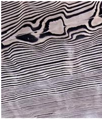
Gambar 5.11. Tekstur Kayu Pinus ( White ) dengan Proses Dibakar
