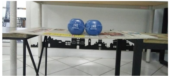
Gambar 4. Panel Koran Ukuran 1 Halaman 50 Lembar dengan Beban 4 kg
