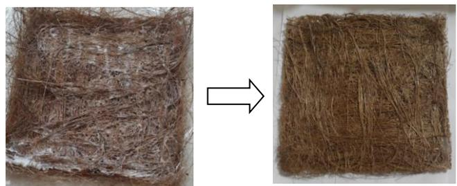
Gambar. 5. Percobaan 5 Menggunakan lem putih dengan perbandingan air 1:1 dan serabut kelapa panjang. Pembuatan dengan merendam serabut kedalam perekat dan menyusun secara menyilang vertikal dan horisontal .
