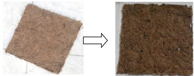
Gambar. 4. Percobaan 4 Menggunakan lem putih dengan perbandingan air 1:1 dan serabut kelapa pendek. Pembuatan dengan cara mencampurkan serabut pendek dengan perekat secara merata .
