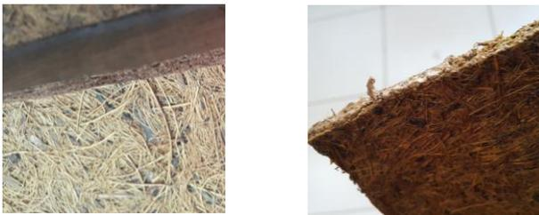
Gambar. 11. Hasil Pemotongan material menggunakan cutter dan menggunakan jigsaw.
