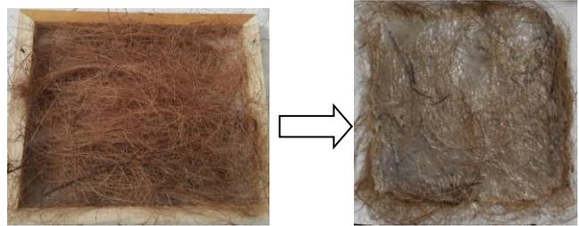
Gambar. 3. Percobaan 3 menggunakan lem putih dengan perbandingan air 1:1 dan serabut kelapa panjang. pembuatan dengan cara disiram.
