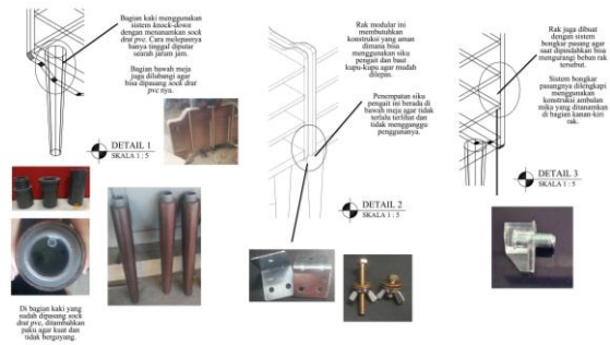
Gambar 18. Detail Konstruksi Rak
