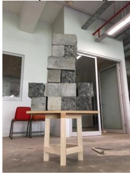
Gambar 21 rangka kayu menahan beban beton 254 kg
