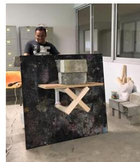
Gambar 26 pembebanan rangka kursi dengan 75 kg beton
