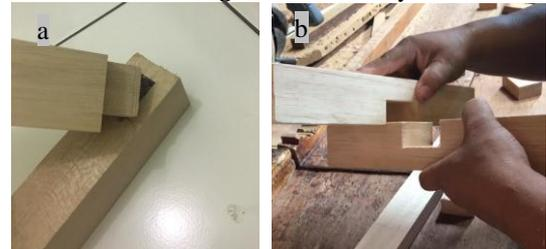
Gambar 19 (a) Join Mortise-tenon, (b) Join half-lap Rangka kursi dengan dimensi 40x40x45 cm (ukuran batang 5x5 cm) ini seluruhnya terdiri dari kayu balsa dengan density yang rendah. Menggunakan join mortise-tenon dan juga half-lap di mana semua bagiannya digabungkan hanya dengan knockdown dan belum direkatkan menggunakan lem. Berat dari rangka kursi ini 1002 g (1,02kg)
