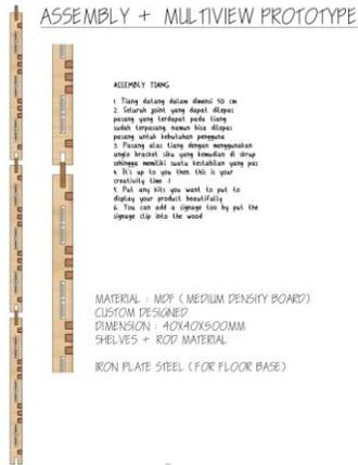
Gambar 16. Detail Modul Utama Tiang Sebelum Disambung
