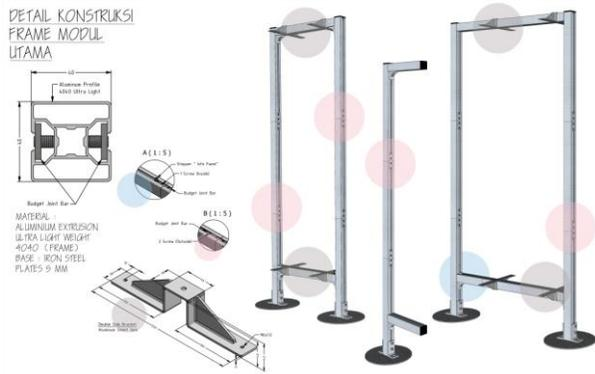
Gambar 27. Isometri dan Detail Modul 30, 50 dan 75
