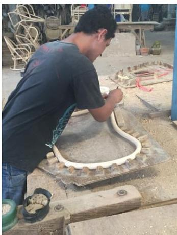
Gambar 14. Proses penyesuaian dengan mal
