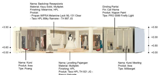
Gambar 7. Potongan D-D' Sumber: Dokumentasi Pribadi, 2017
