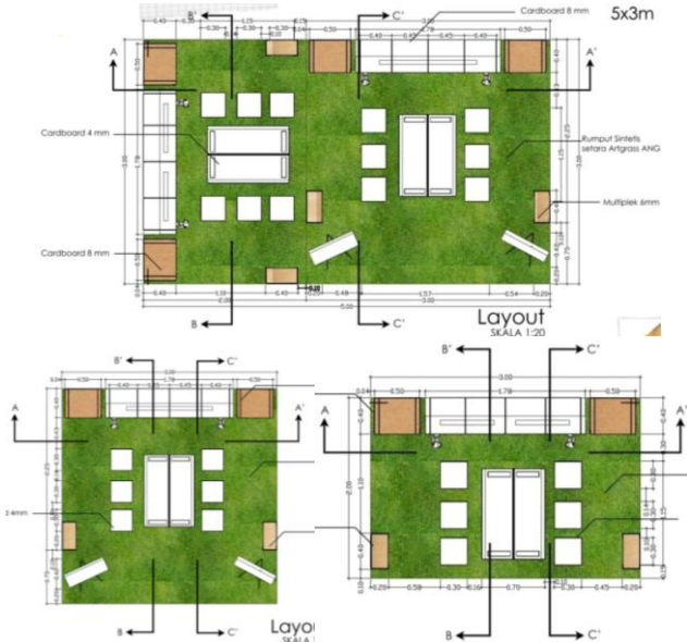
Gambar 4.16. Layout Desain Akhir Alternatif 3 (Home) ukuran 5x3 meter, 3x3 meter, dan 2x3 meter
