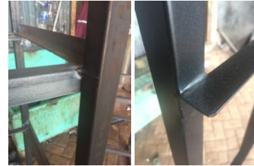
Gambar 4.24. Perbandingan Besi Sebelum Dan Sesudah Finishing
