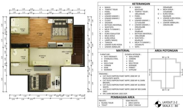
Gambar 16. Layout 2 Lantai 2 (Sumber : Dokumentasi Pribadi)
