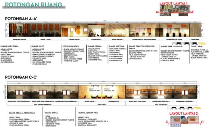
Gambar 11. Tampak Potongan A-A” dan C-C”
