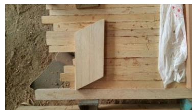
Gambar 10. Teknik rotan laminasi berukuran modul 25x12.5x0.7
