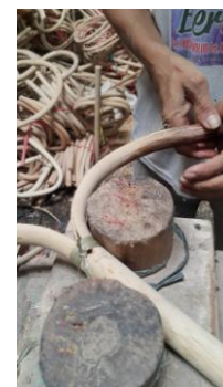
Gambar 26. Bending pada mal
