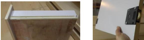
Gambar 8. Pemasangan hardware dan engsel
