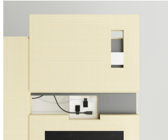
Gambar. 13. Komponen penutup kabel ( charger bay ) Sumber: Dokumentasi Pribadi, 2016
