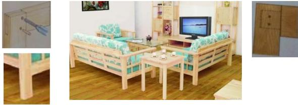
Untuk sambungan kaki sofa dapat menggunakan mortis dan tenon. Ada pisau untuk membuat lubang teon maupun dowel. Alat pisau ini cocok digunakan untuk membuat sambungan pada kayu kelapa karena sifat kayu kelapa yang keras jika di bor menggunakan pisau besi yang tajam tidak akan mudah pecah serat.
