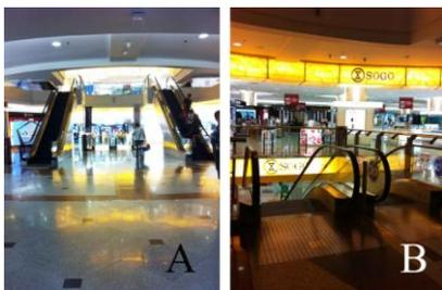
Gambar 17. Eskalator di "Tunjungan Plaza" 4 dengan konfigurasi *paired paralel* (A) dan *stacked escalator* (B)
