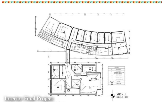
Gambar 10. Mekanikal elektrik lantai 1
