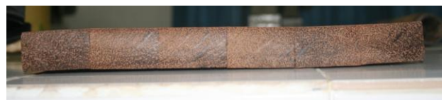
Gambar. 3. Pelengkungan konstruksi dowel pada hari pertama.
