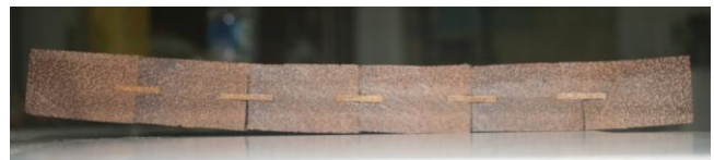
Gambar. 2. Melengkungnya konstruksi isian pada hari pertama.
