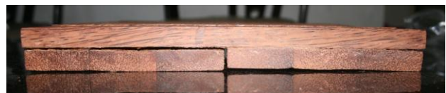
Gambar. 1. Lepasnya konstruksi laminasi yang disusun berlawanan arah serat pada hari pertama.
