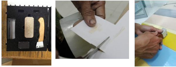
Gambar 1.3 Alat Bantu Pengujian Daya Lekat Sumber: Dokumen Pribadi (2014)
