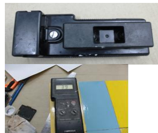
Gambar 1.2 Alat Bantu Pengujian Daya Kilap Sumber: Dokumen Pribadi (2014)
