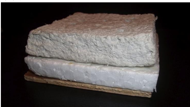
Gambar 13. Contoh lapisan yang akan digunakan sebagai panel akustik alternatif. (sumber: dokumentasi pribadi, 11 Mei 2014)
