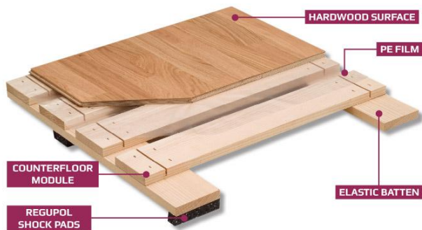
Gambar 19. Konstruksi untuk permukaan lantai lentur
