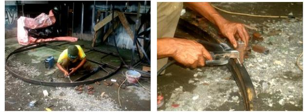
Gambar 14. proses pengelasan besi
