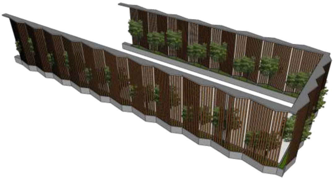
Gambar 26. Desain Alat Pembayangan Pasif, Sumber: Hasil analisis
