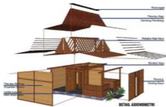
Gambar 5. Penggunaan bahan bangunan pada rumah Osing, Sumber : Perbub Banyuwangi No 11 Tahun 2019
