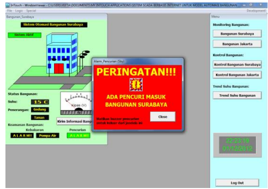
Gambar. 9 Pengujian sistem keamanan bangunan dari bahaya pencuri
