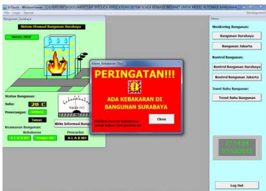
Gambar. 8 Pengujian sistem keamanan bangunan dari bahaya kebakaran
