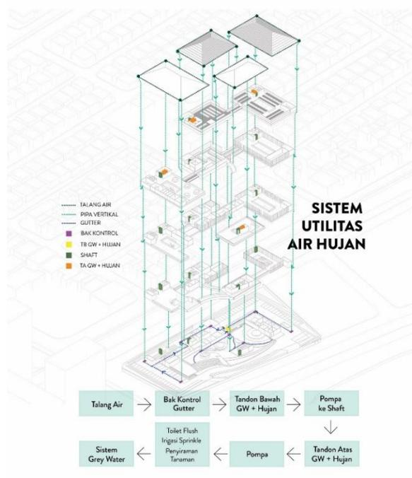
Gambar 3.9. Isometri sistem utilitas air hujan
